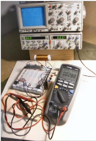
Abb. 3 Aufbau der 3-Spannungsmesser-Methode auf einer Hirschmann XP101-Platine
