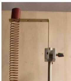
Abbildung 6 Halterung der (Plastik-)Schraubenfeder. Der unterhalb des Metallwinkels herabhängende Teil der Feder ist aktiv.
