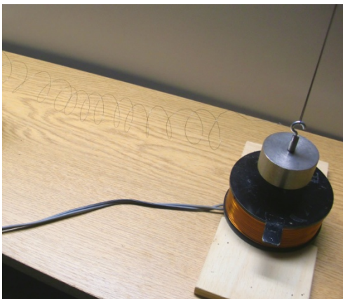
Abbildung 4 Magnetspule unter dem Pendel mit konstanter Länge (Eigenfrequenz f_0 ). Ein Teil der Kopplungsfeder ist erkennbar. Sie besteht aus ca. 14 Windungen 0,2 \text{ mm}^\circ Eisendraht, gewickelt zu einer Spirale mit 3 \text{ cm} Durchmesser, die Messung der Federkonstanten ergab D = 0,05 \text{ N/m} .
