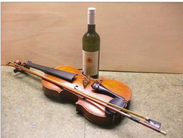
Abbildung 2 Weinflasche und Geigenkorpus als Helmholtz-Resonatoren
