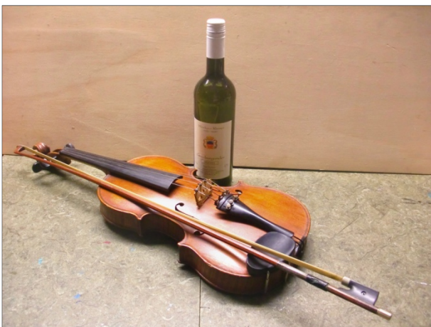
Abbildung 2 Weinflasche und Geigenkorpus als Helmholtz-Resonatoren
