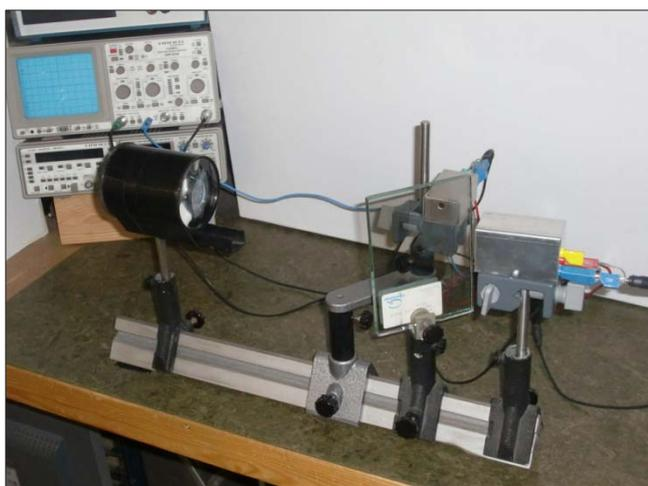
Abbildung 1 Messung der Lichtgeschwindigkeit nach der Laufzeitmethode. Anordnung von Sender, Empfänger, halbdurchlässigem Spiegel und Epidiaskop-Objektiv (siehe Text). Sender und Empfänger wurden von U. Ihlefeldt<sup>1</sup> entworfen und unter seiner Anleitung zusammengesetzt. Die Laufstrecke schließt sich links an die optische Bank an. Der Reflektor an dessen Ende befindet sich außerhalb des Bildes.
