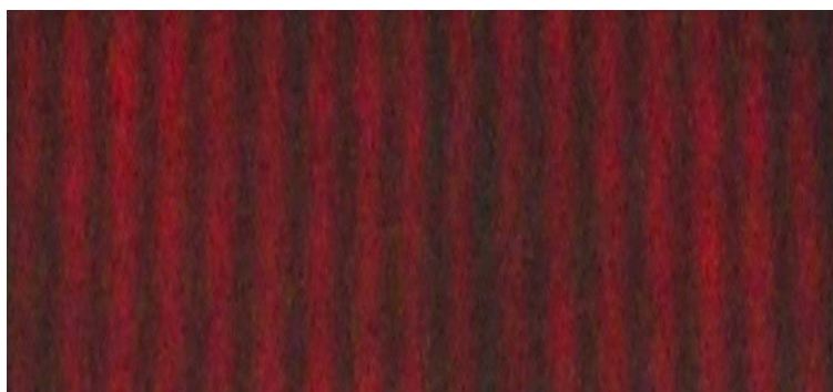
Abbildung 4 Foto der Interferenzstreifen auf dem Schirm
