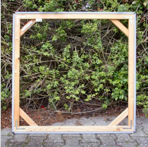
Abbildung 1 Foto der Antenne. Der Holzrahmen hat eine Seitenlänge vom 1 m. An seiner Außenseite ist der Kabelkanal (in grauer Farbe) zu erkennen, in dem die 600 Windungen des Antennendrahts untergebracht sind.
