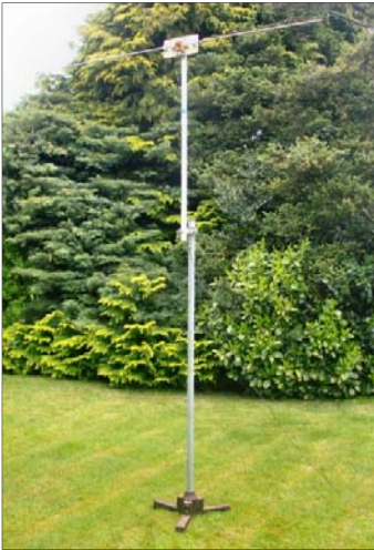
Abbildung 2 Im Text beschriebener Dipol der Länge L = 1,55 m in einer Höhe h = 2,50 m über dem Boden. Wegen der Büsche im Hintergrund kein idealer Standort, für einen Test des Vektor-Antennen-Analysators FA-VA5 ist dies aber unerheblich.
