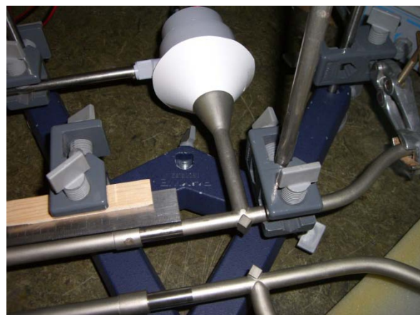
Abbildung 2b) Lautsprecher und Trichter zum Einspeisen des Schalls
