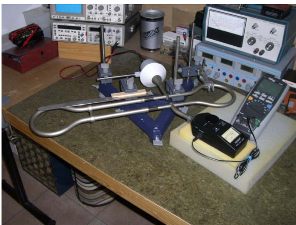
Abbildung 2a) Messanordnung mit Quincke-Rohr, Pegelmesser und Datenlogger
